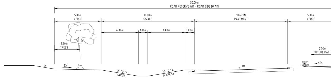
TYPICAL CROSS SECTION OF LOCAL ROAD WITH SWALE
